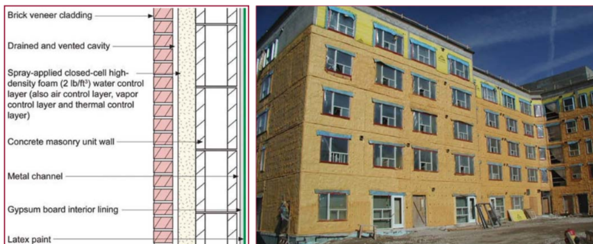
Figur 5: Konstruktionsdetaljer för vägg med utvändigt applicerat sprayskum (Lstiburek 2010)
